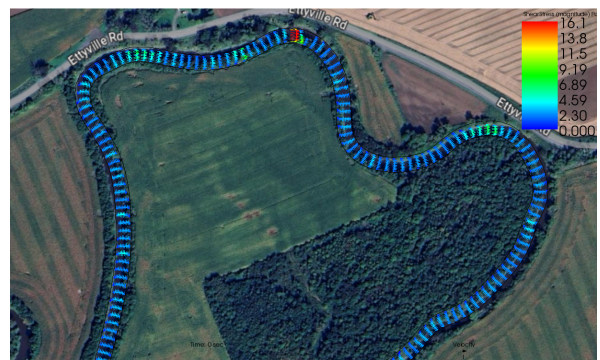
(d) Critical Shear Stress Distribution
